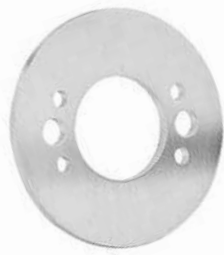
IN.LERP Espelho desenhado para ocultar furações de anteriores aplicações de puxadores. Por exemplo fechaduras tubulares. Aplicável sob qualquer roseta redonda JNF. Diâmetro 60mm / Plate designed to occult holes of previous applications of door handles. For example tubular locksets. Applicable under any round JNF rose. Diameter 60mm / La placa diseñada para ocultar los agujeros de anteriores manillas. Por ejemplo cerraduras tubulares. Apliable debajo de cualquier roseta redonda JNF. Diametro 60mm.
